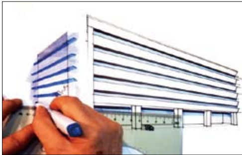
3 為了表示玻璃材質，上彩同時轉動筆尖，筆尖從左向右由細變粗。
