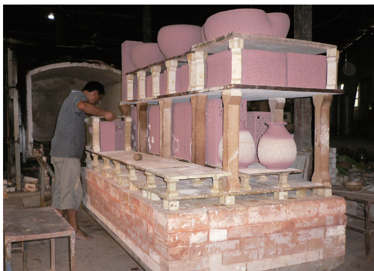
圖5-26 台車式瓦斯窯／苗栗金龍窯
