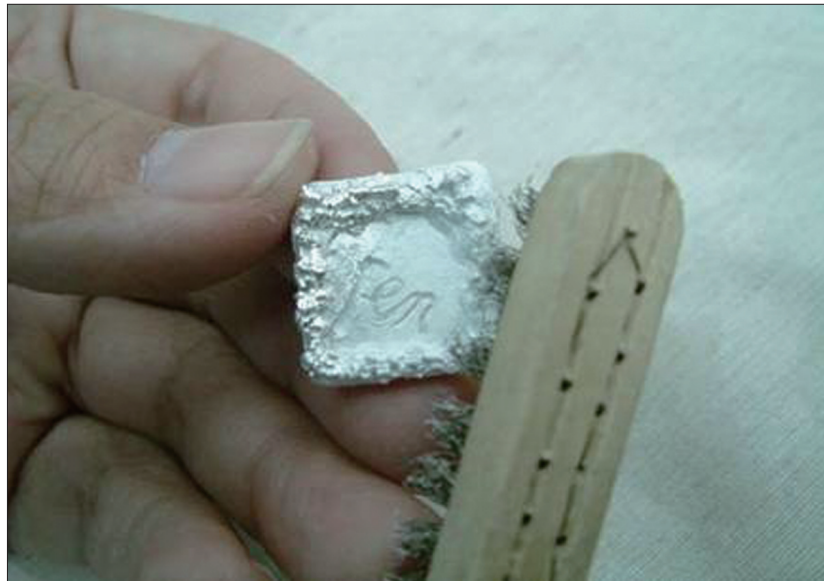
圖8-50 用不鏽鋼刷表面則可顯現銀光澤
