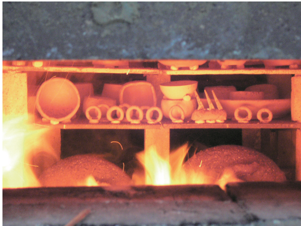
圖5-28 升溫中的柴窯（約1000°C）
