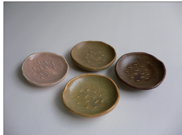
圖5-13 劉鎮洲／石膏模壓模成形的小碟子
