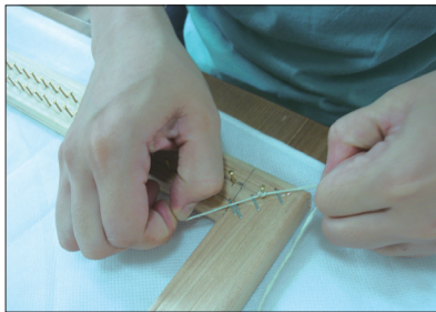
圖7-39 釘好之後，再在外線兩邊各釘下一釘子，做為固定樁。
