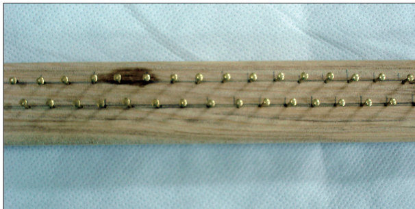
圖7-37 製作編織木框的方法
