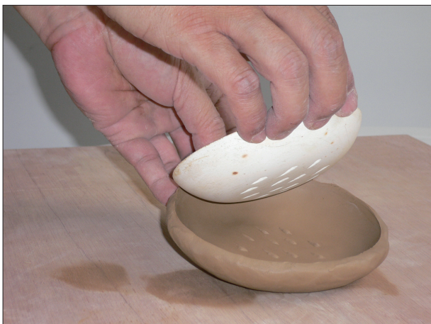
圖5-12 利用石膏模壓模成形
