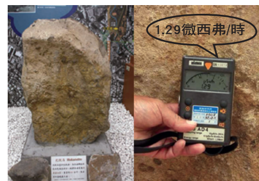
北投溫泉博物館鎮館之寶—北投石，其表面劑量率：1.29微西弗/時。
