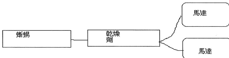
圖一、實驗裝置。以兩個馬達並聯，打氣通過乾燥劑後吹入裝有蜥蜴的管中。
